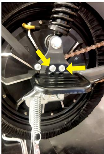
Posicione o suporte do descanso de pé no local indicado, insira os parafusos e aperte-os firmemente.
