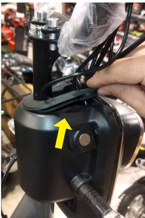
Encaixe o anel de borracha na carenagem do painel já montado.
