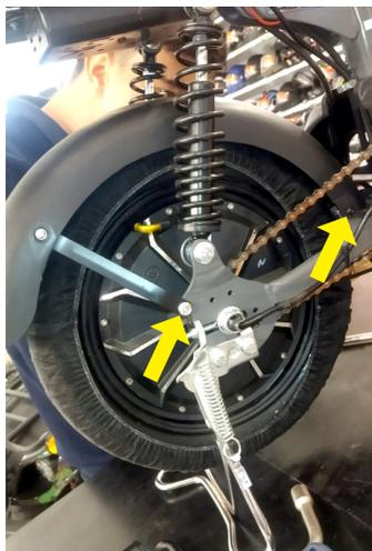
Encaixe o para-lama traseiro e aperte os parafusos indicados.
