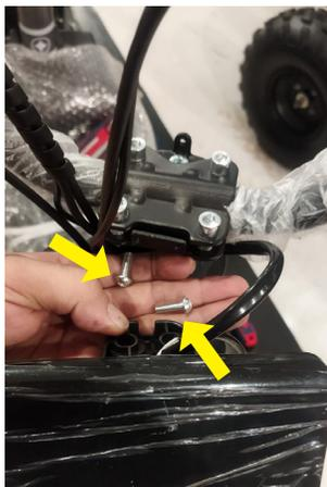
Fixe o painel de velocidade no guidão utilizando os parafusos indicados na foto.
