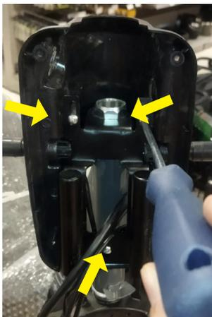
1. Posicione os três parafusos indicados sem apertar completamente — o aperto final será feito no próximo passo.
