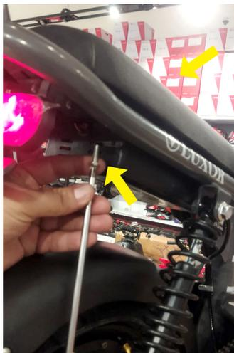
Posicione o banco traseiro e aperte firmemente os parafusos de fixação.
