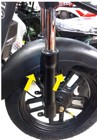
Encaixe o para-lama dianteiro e aperte os parafusos indicados.
