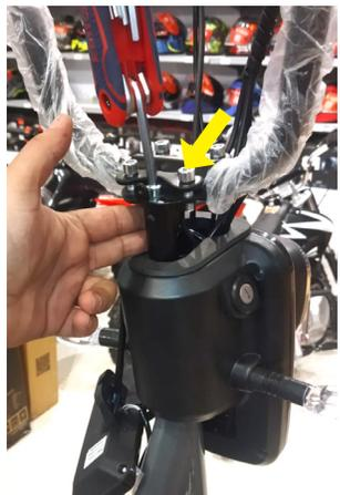
Aperte os parafusos da mesa do guidão. Ajuste a altura, centralize e alinhe o guidão com a roda dianteira.
