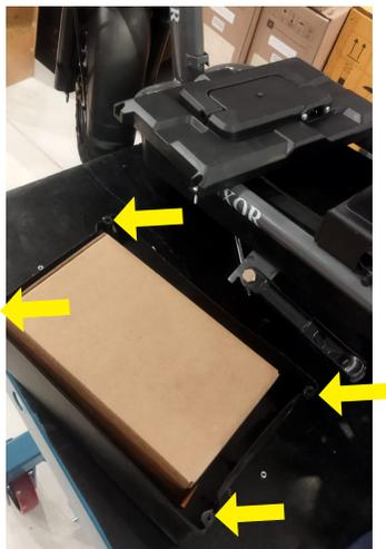
Afrouxe os quatro parafusos localizados nos cantos da caixa da bateria, remova-os e abra a tampa da caixa.
