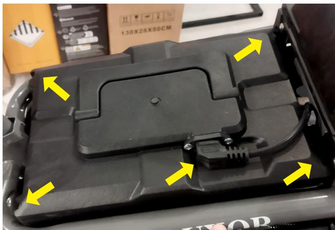
Após concluir o passo anterior, recoloca a tampa da caixa da bateria, insira os quatro parafusos nos cantos e aperte-os firmemente.
