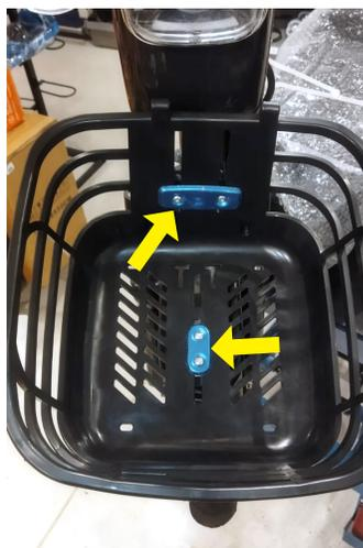
Coloque a cestinha frontal na posição correta e aperte os parafusos de fixação.
