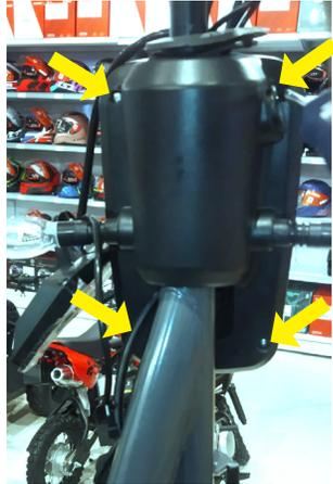
Encaixe a carenagem frontal do farol e, em seguida, aperte os quatro parafusos indicados.
