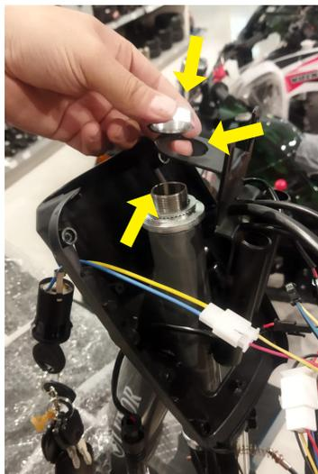
Remova a porca de fixação e encaixe o suporte metálico central da carcaça no parafuso central do guidão.
