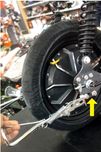
Fixe firmemente os parafusos do cavalete central de apoio.
