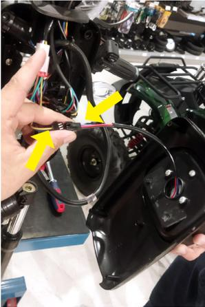
Encaixe e conecte o chicote do farol e, em seguida, aperte os quatro parafusos indicados.
